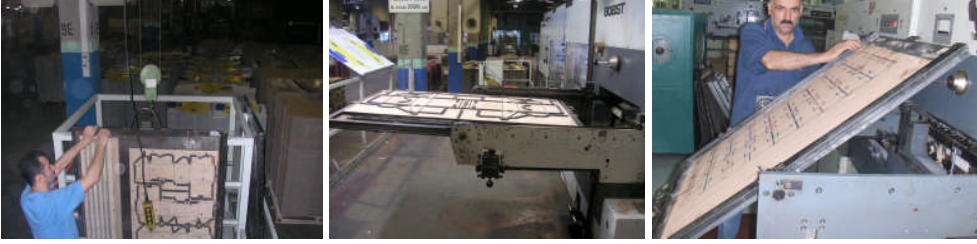
Resim 3.3: Çoklu kesim makinesi kalıp sisteminin taşındığı araç ve takıldığı şase
